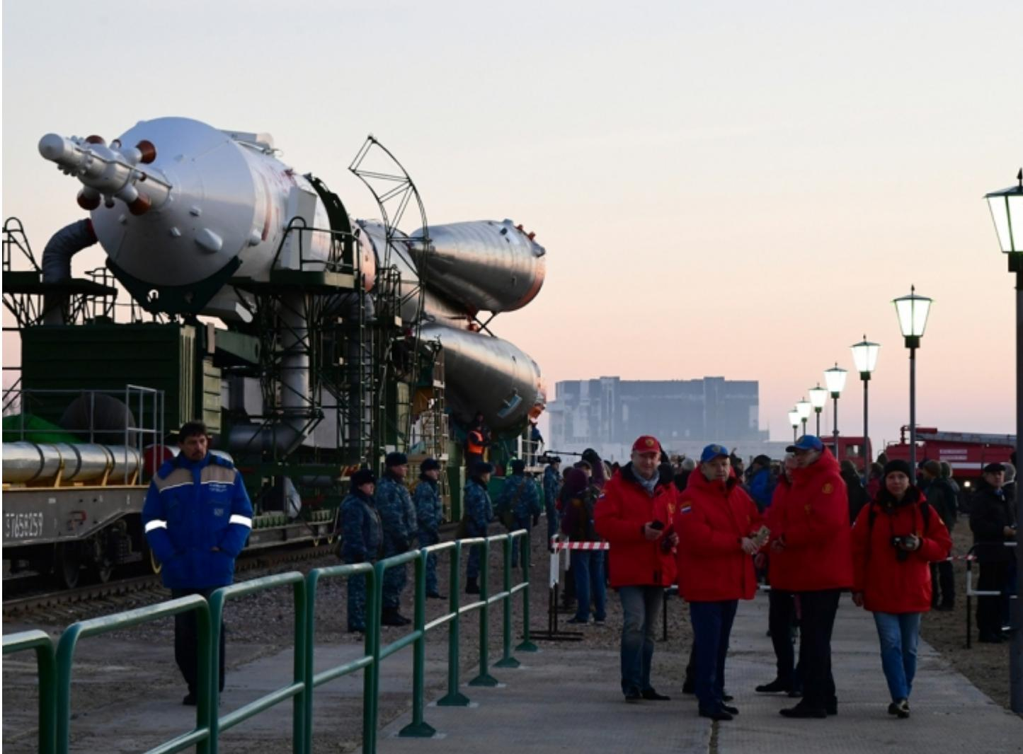
12 марта 2019 года осуществлен вывоз ракеты-носителя (РН) «Союз-ФГ» с транспортным пилотируемым кораблем (ТПК) «Союз МС-12» из монтажно-испытательного корпуса на стартовую площадку. Ракета космического назначения установлена в стартовом сооружении площадки № 1 («Гагаринский старт») космодрома Байконур. Проводятся работы по программе первого стартового дня.
